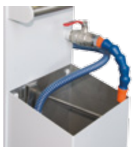
Odvádění cizích olejů do nádoby se spínačem hladiny (ochrana proti přetečení)
