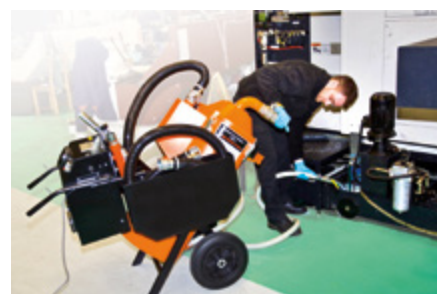
Vrácení vyčištěné emulze do nádoby s chladícím mazivem
