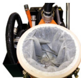
Filtrovní vložka s třísčkami a kalem po broušení
