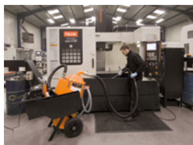
Nasávání znečištěné emulze, třískek a kalu po broušení
